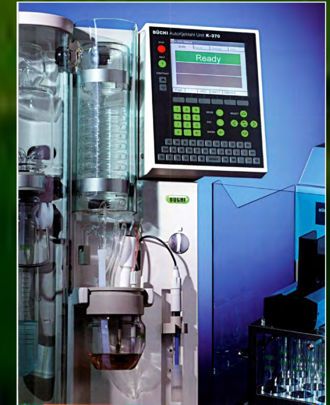
Equip per a determinar el contingut de nitrogen en materials orgànics pel mètode Kjeldahl.
